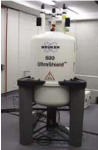
a sinistra: il magnete, importante componente dello strumento Bruker Avance DMX 600 a destra: tipico segnale FID – free induction decay del decadimento protonico
